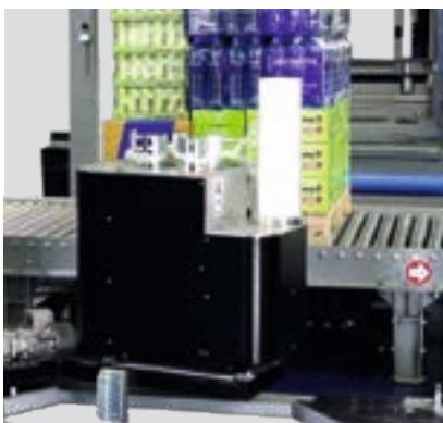
ARC - CHANGEMENT DE BOBINE AUTOMATIQUE Dispositif de remplacement automatique d'une bobine de film étirable vide par une nouvelle bobine pleine ARC - AUTOMATISCHER ROLLENWECHSLER Vorrichtung zum automatischen Ersetzen einer leeren Stretchfolienrolle durch eine neue Folienrolle
