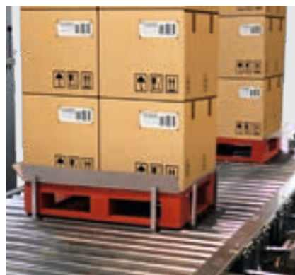
SYSTÈME DE PLIAGE INFÉRIEUR Dispositif pour permettre l'emballage des rabats inférieurs sur intercalaires avec ou sans palette en bois UNTERES FALTSYSTEM Vorrichtung zum Wickeln von unteren Umschlägen auf Zwischenbögen mit oder ohne Holzpalette
