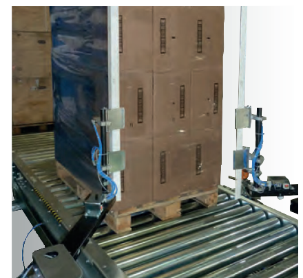
SYSTÈME DE DÉPOSE DE CORNIÈRES VCA Dispositif pour l'application de cornières en carton pour la protection des angles de la palette
