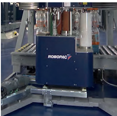
ARC - CHANGEMENT DE BOBINE AUTOMATIQUE Dispositif pour le remplacement de la bobine de film
