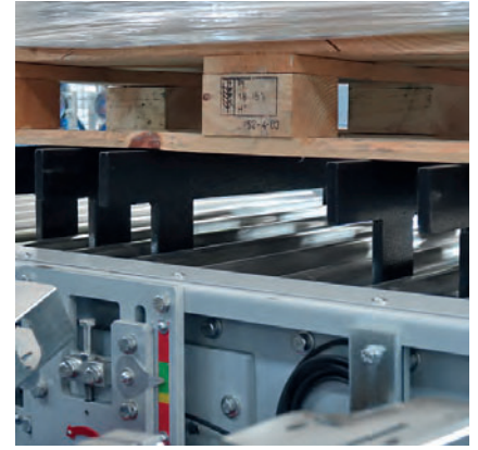
ELÉVATEUR DE PALETTE Dispositif de soulèvement de la palette PALETTENHEBER Vorrichtung zum Anheben der Palette
